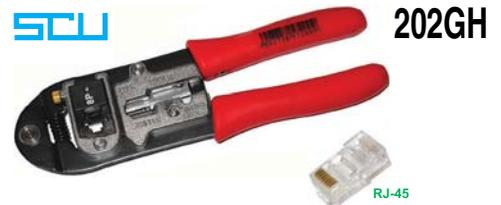
Tipo ad apertura automatica a fine bloccaggio. In acciaio speciale, parti operanti temprate e rettificata. Impugnatura rivestite in materiale sintetico. Per troncatura e spelatura di cavi piatti con lunghezza mm 6 e 12. Per serrare terminali modulari tipo "Western", particolarmente utilizzati in telefonia e sistemi di comunicazione.
