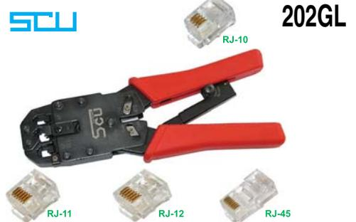
Tipo ad apertura automatica a fine bloccaggio. In acciaio speciale, parti operanti temprate e rettificata. Impugnatura rivestite in materiale sintetico. Con dispositivo di sbloccaggio in caso di cablaggi difettosi. Per troncatura e spelatura di cavi piatti con lunghezza mm 6 e 12. Per serrare terminali modulari tipo "Western", particolarmente utilizzati in telefonia e sistemi di comunicazione.
